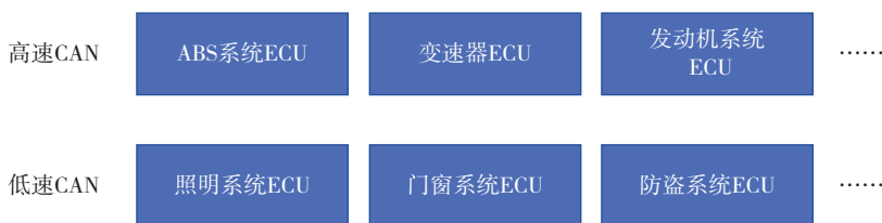
图 1-6 基于 CAN 总线的状态数据采集
