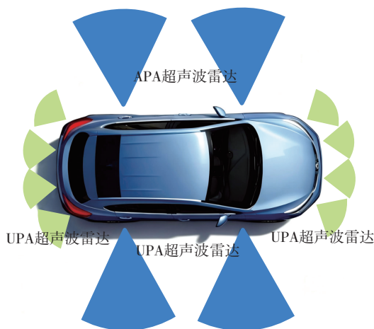
图 2-2 12 颗超声波雷达布置方案示意图
