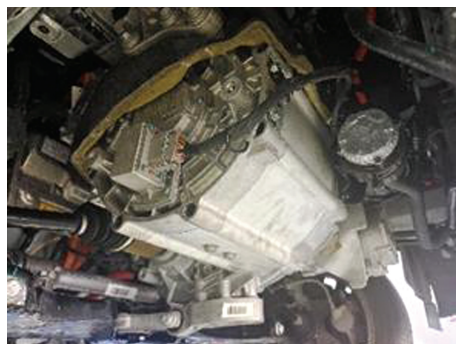
图 2-9 吉利 EV450 驱动电机外观图
