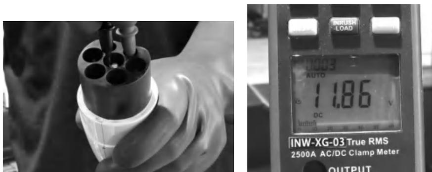
图 4-18 测量交流充电枪 CP 与 PE 间电压
