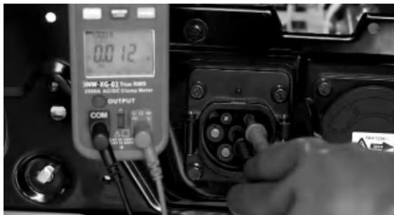
图 4-25 测量 CC 与 PE 间电压
