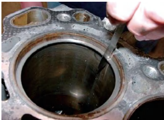
图 4-12 用厚薄规测量活塞环端隙
