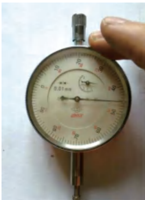
图 4-45 观察百分表指针的灵敏度
