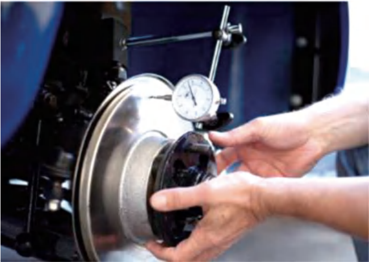
图 4-41 用百分表测量制动盘振摆
