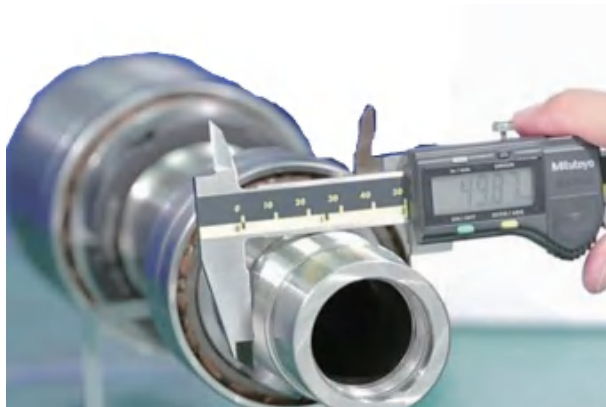
图 4-20 测量启动机换向器直径 (本田飞度轿车)
