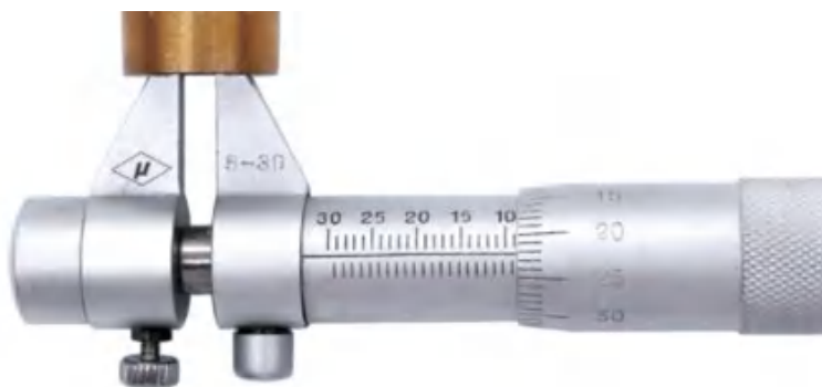
图 4-27 用内径千分尺测量衬套内径
