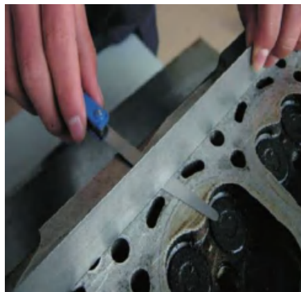
图 4-13 将厚薄规与靠尺 配合使用检测汽缸盖翘曲
