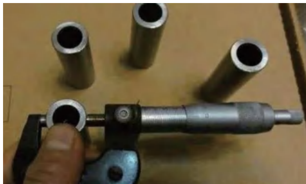
图 4-26 用外径千分尺测量曲轴轴颈、活塞、活塞销直径
