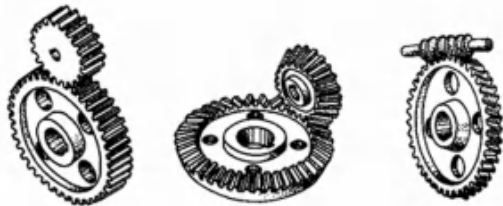
(a) 圆柱齿轮传动 (b) 圆锥齿轮传动 (c) 蜗杆蜗轮传动
