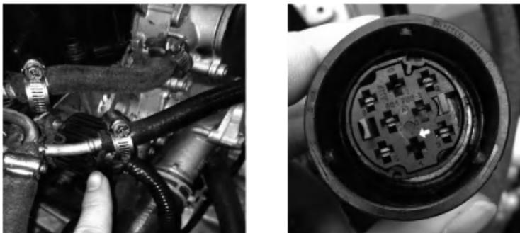
图 4-22 检查气缸盖处插头端子间的泵喷嘴电阻
