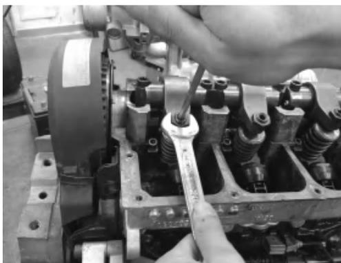
图 4-29 拧松调螺钉至规定位置并锁止螺母
