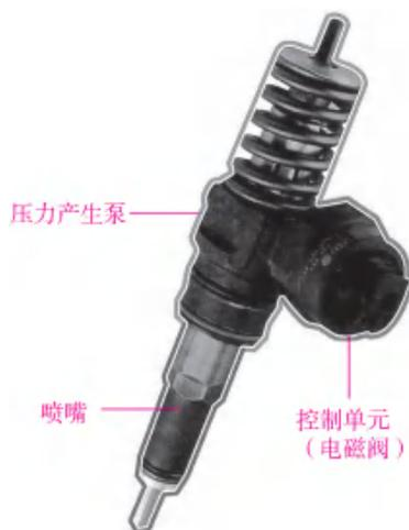
图 4-16 泵喷嘴结构
