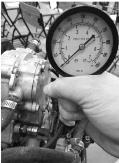
图 4-30 连接压力表接头至输油泵
