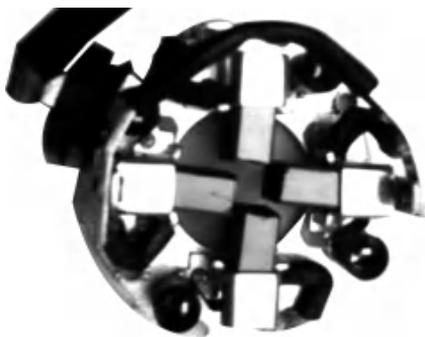
图 2-5 电刷架总成
