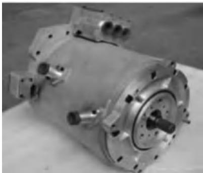
图 2-22 永磁同步电机外形
