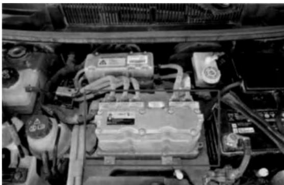
图 2-32 电力电子箱在车上的位置
