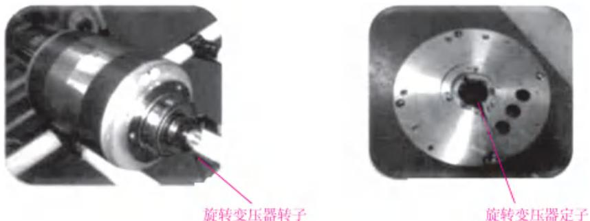
图 2-28 旋转变压器转子、定子
