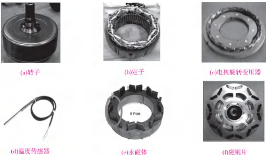
图 2-23 永磁同步电机组件
