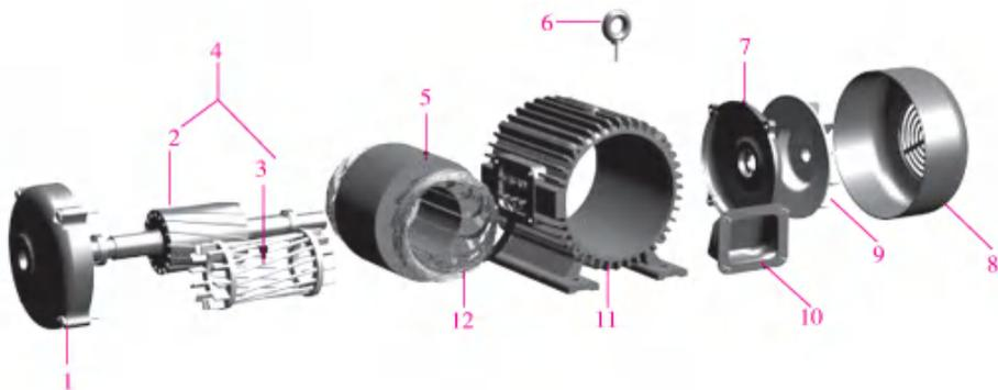
1—前端盖；2—转子铁芯；3—转子绕组；4—转子部分；5—定子铁芯；
