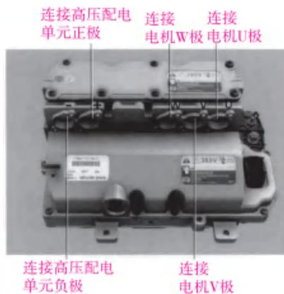
图 2-33 电力电子箱外部连接口
