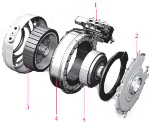
1—高压线接口；2—后端盖；3—永磁转子；4—多极绕组定子；5—离合器
